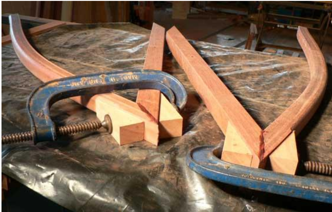
Photo 4. Glueing up the leg/rocker mitres.
